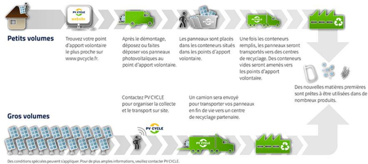
Figure 58 : Schématisation du traitement des modules après démantèlement
